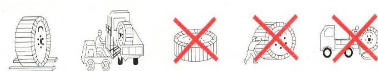
Schéma manipulace s OPGW (Obrázek 1)
